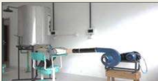
Figura 03. Sistema de secagem de grãos por convecção forçada
