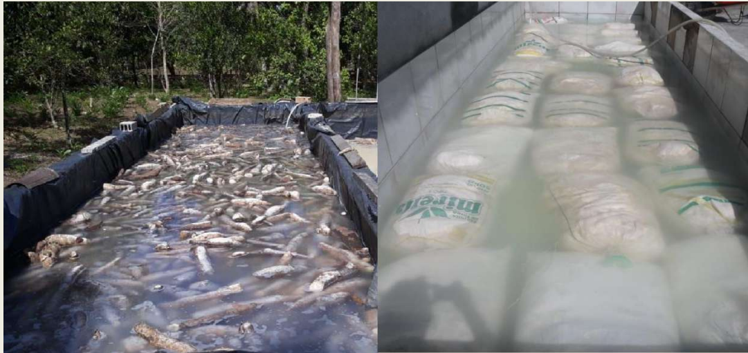
Figura 1: A - Tanque revestido com lona, submersão por três dias; B – Tanque, submersão em água por doze horas.
