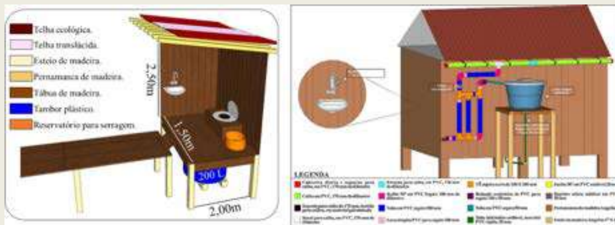
Figura 2: Planta baixa do BER e do sistema de captação e armazenamento da água da chuva..
