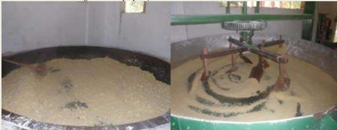
Figura 2: A - preparação manual no forno; B - forno elétrico.
